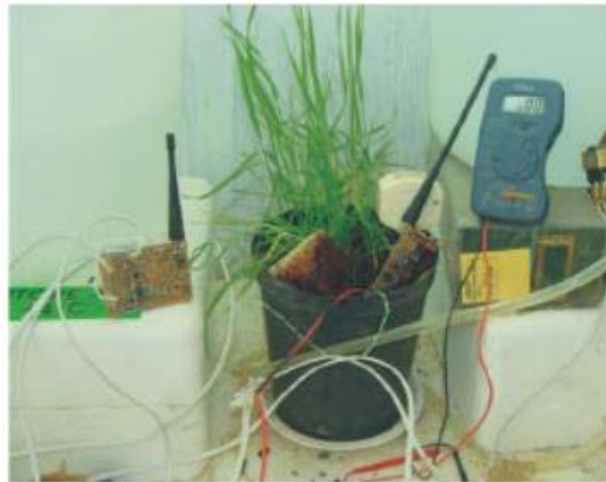
شکل ۸- سامانه آبیاری هوشمند ریزمقیاس (آزمایشی) برای گیاهان گلدانی (Atta et al., 2011)
