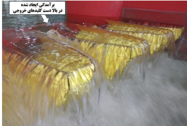
شکل ۶. برگشت جریان در کلیدهای ورودی و برآمدگی در کلیدهای خروجی سرریز کلید پیانویی دوزنقه‌ای با شیب ۵ درجه خلاف جهت جریان
