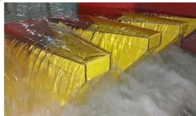
شکل ۳. سرریز کلید پیانویی دوزنقه ای با شیب 7/5 درجه خلاف جهت جریان
