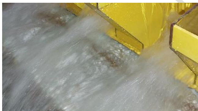
شکل ۵. آشفستگی زیر کلیدهای ورودی در سرریز کلید پیانویی دوزنقه‌ای با شیب ۵ درجه خلاف جهت جریان
