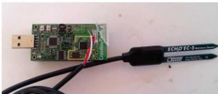
شکل ۳- سنسور رطوبت خاک EC-5 (Angelopoulos et al., 2011)
