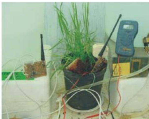
شکل ۸- سیستم آبیاری هوشمند ریزمقیاس (آزمایشی) برای گیاهان گلدانی (Atta et al., 2011)
