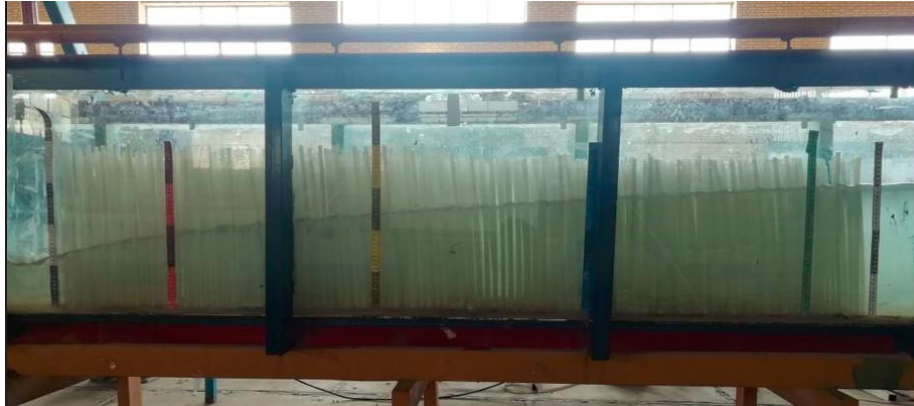
شکل ۲. فلوم مورد بررسی همراه با پوشش گیاهی صلب (جهت جریان از راست به چپ)
