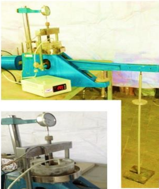
شکل ۶- دستگاه تحکیم نمونه‌های خاک با قابلیت اعمال حرارت بر روی نمونه‌های مورد آزمایش
