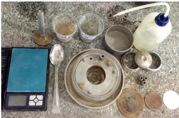
شکل ۴- وسایل مورد نیاز برای ساخت نمونه
