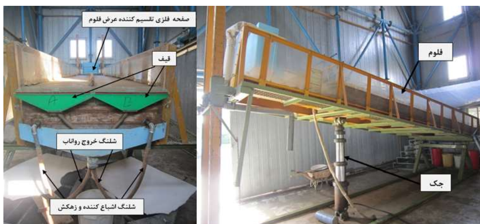
شکل ۱- نمایی از پهلو (راست) و خروجی (چپ) فلوم آزمایشگاه شبیه‌ساز باران و فرسایش پژوهشکده حفاظت خاک و آبخیزداری
