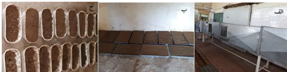
شکل ۱- نمایی از دستگاه تونل باد مورد استفاده (الف)، سینی‌های حاوی خاک پس از اعمال تیمارها (ب)، ظروف پلاستیکی با ابعاد ۲۲۰ × ۱۳۰ × ۵۰ میلی‌متر حاوی خاک پس از اعمال تیمارها (ج).
