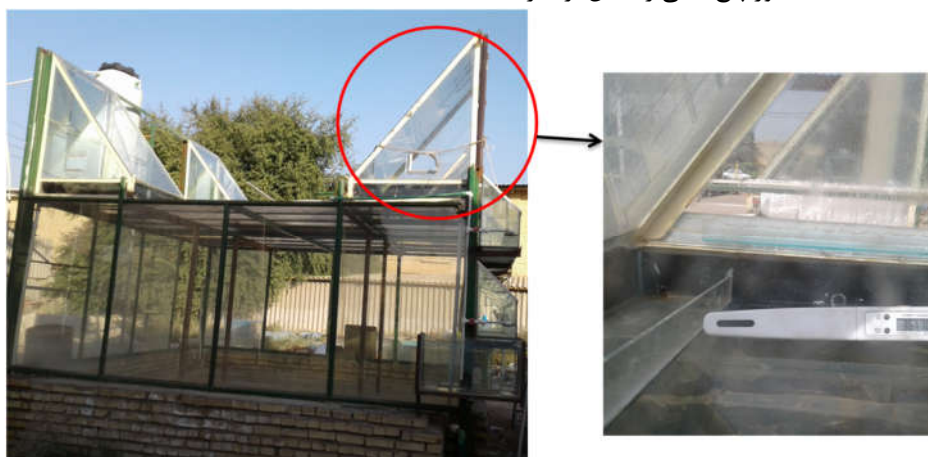
شکل ۱. نمایی از گلخانه با چهار دستگاه تقطیرگر خورشیدی در سقف و دو دستگاه در دیواره جنوبی آن
