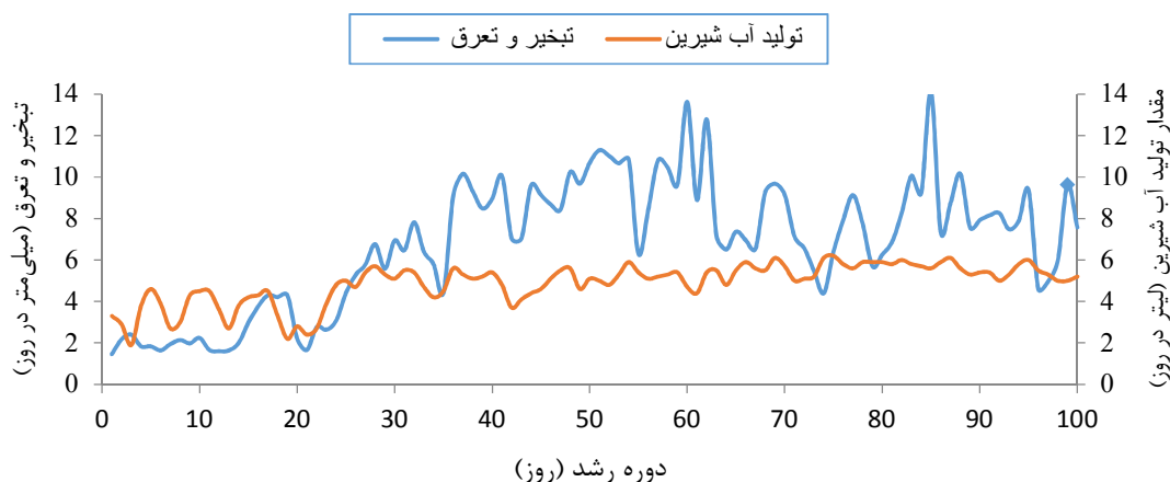
شکل ۱۳. روند تغییرات روزانه تبخیر و تعرق گیاه ریحان در طول فصل رشد در مقابل تغییرات روزانه تولید آب شیرین
