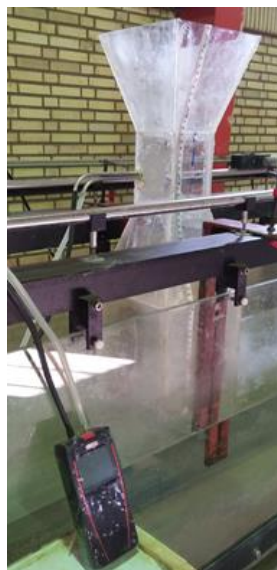
شکل ۳. لوله پیتوت نوع S مورد استفاده در آزمایش‌ها و نحوه قرارگیری آن در مدل آزمایشگاهی
