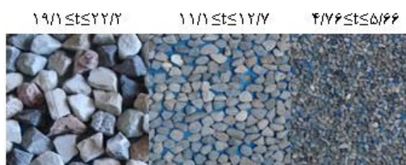
شکل ۲. زبری‌های سنگریزه‌ای دانه‌بندی شده
