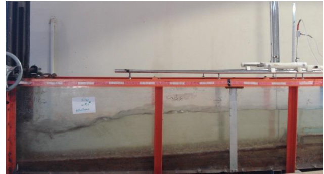
شکل ۳. نمونه پرش مستغرق در زبری 11/12 \leq t \leq 14/17 ، شیب ۵٪ و پله انتهایی ۶ سانتیمتری
