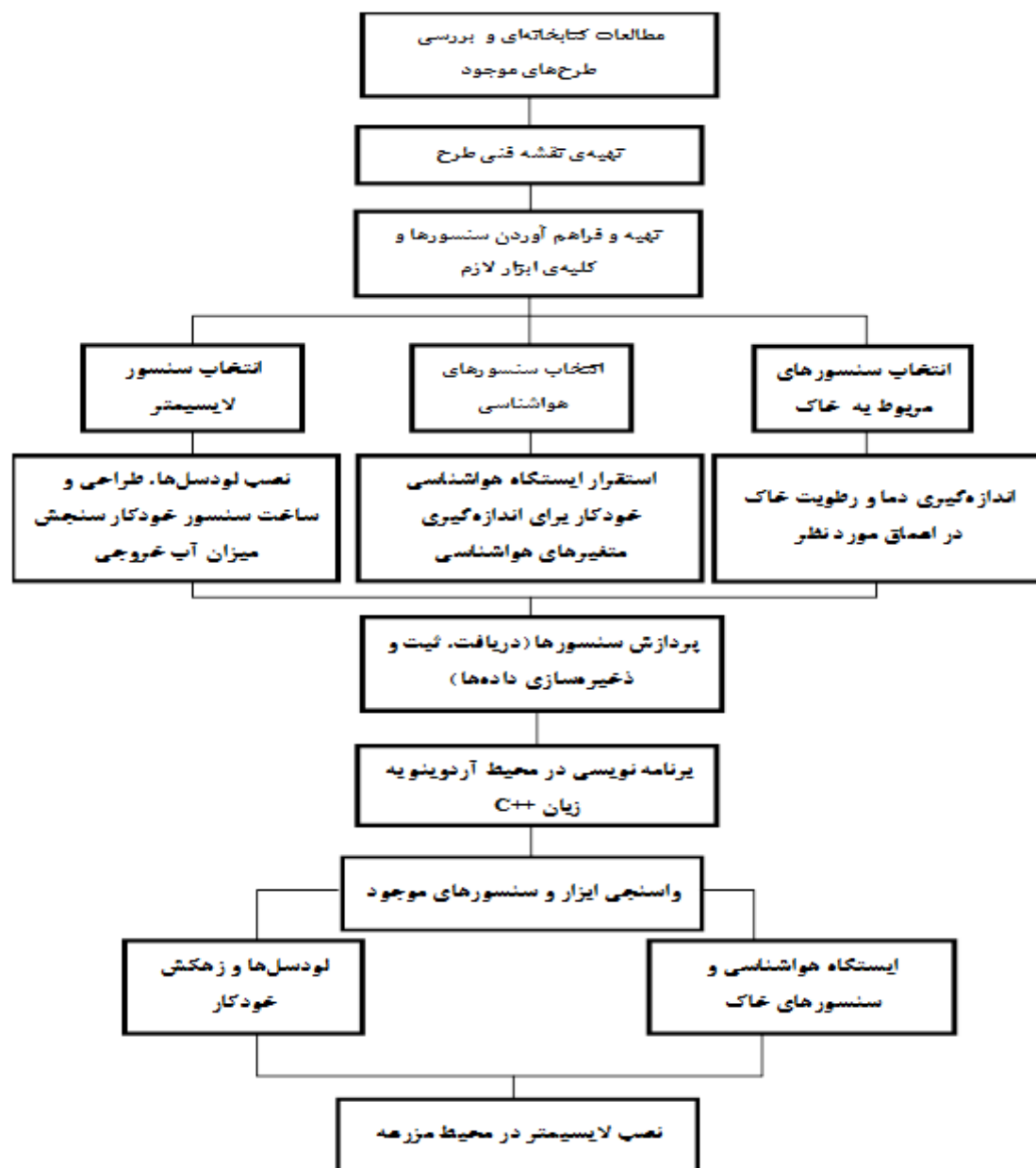
شکل ۱. مراحل و روند انجام پژوهش جهت طراحی و ساخت لایسیمتر کوچک خودکار
