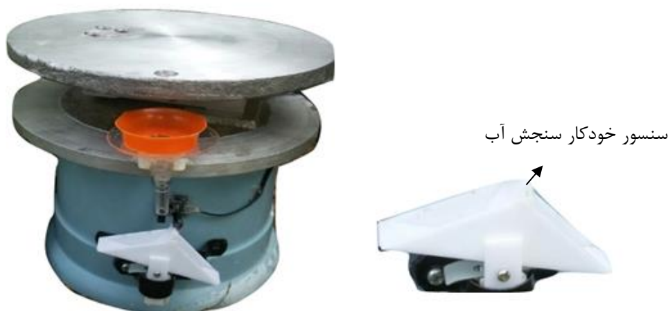
شکل ۴. زهکش خودکار طراحی شده جهت اندازه‌گیری آب خروجی از سیلندر لایسیمتر
