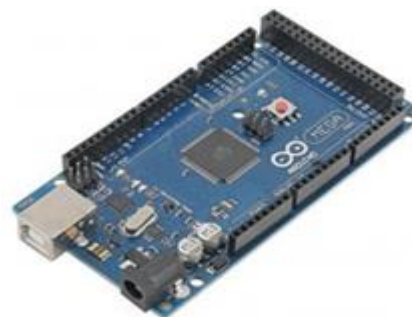
شکل ۷. الف- دیتالاگر (برد آردوینو) و ب- ماژول GSM بی‌سیم نصب شده جهت ثبت خودکار داده‌های میکرو لایسیمتری
