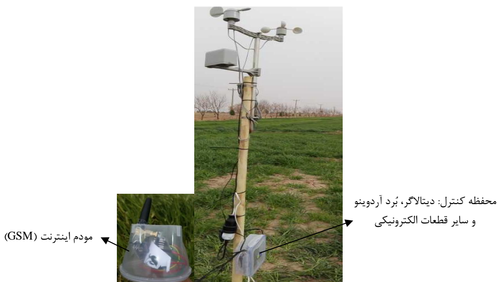
شکل ۵. ایستگاه هواشناسی خودکار نصب شده در مجاورت لایسیمتر کوچک هوشمند واقع در مزرعه دانشگاه شهید باهنر کرمان
