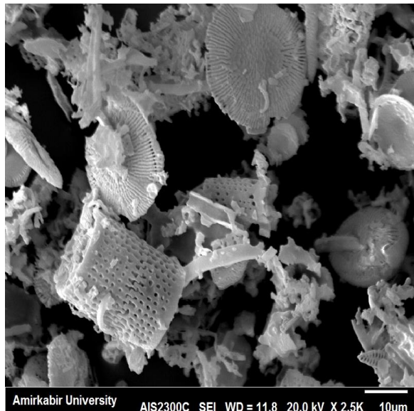
شکل ۲. تصاویر SEM دیاتومیت ایران و دیاتومیت فرانسه
