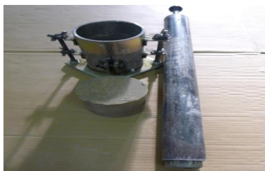
شکل ۳- مولد، چکش و نمونه متراکم شده
