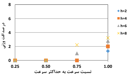
شکل ۱۹- درصد افت وزنی نمونهها در ۱۲٪ سیمان، \Theta=60^\circ
