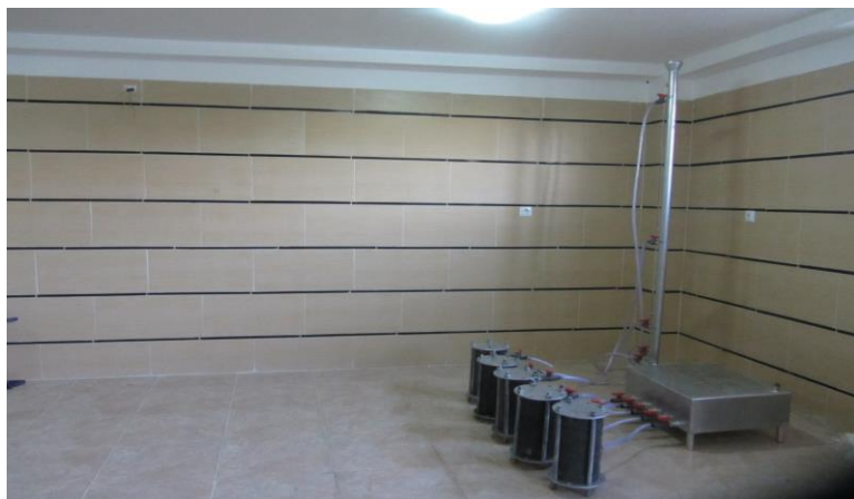
شکل ۳. دستگاه آبشویی گچ مورد استفاده در این پژوهش
