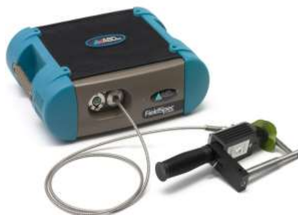
شکل ۲. تصویری از دستگاه بازتاب‌سنج طیفی خاک (FieldSpec@3, ASD, FR, USA)
