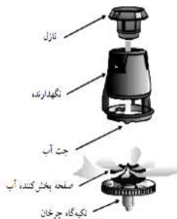
شکل ۲. نازل دوار صفحه آبی شرکت نلسون
