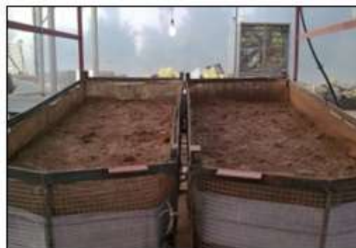
شکل ۱- نمای از فلوم‌های آزمایشی پس از اعمال باران
