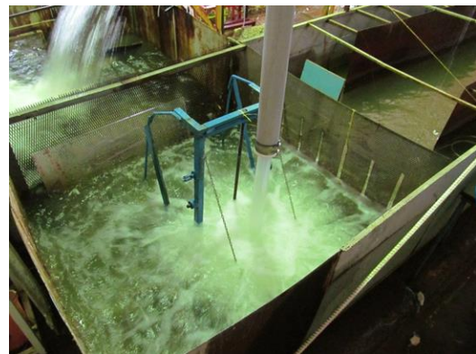
شکل ۳- نمایی از مدل جت خروجی از نازل و صفحه برخورد
