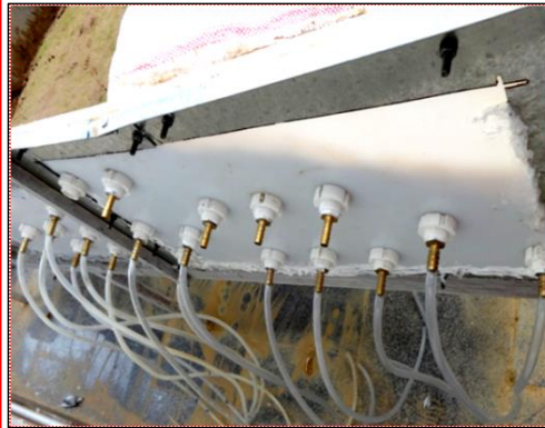
شکل ۴- الف) محل نصب پیزومترها در مدل آزمایشگاهی و ب) نحوه قرارگیری پیزومترها در داخل خاک
