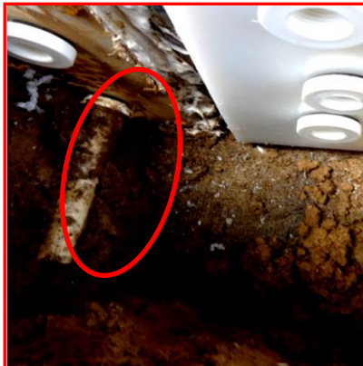
شکل ۴- الف) محل نصب پیزومترها در مدل آزمایشگاهی و ب) نحوه قرارگیری پیزومترها در داخل خاک
