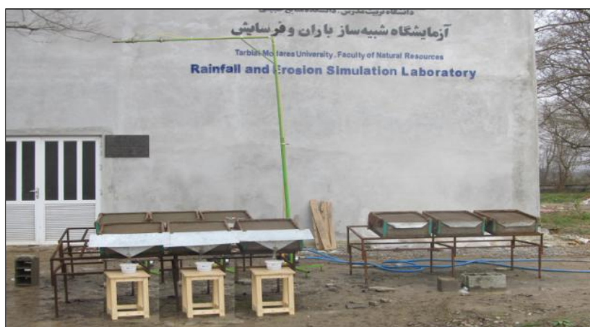
شکل ۱. کرت‌های کوچک فرسایشی و دستگاه شبیه‌ساز باران
