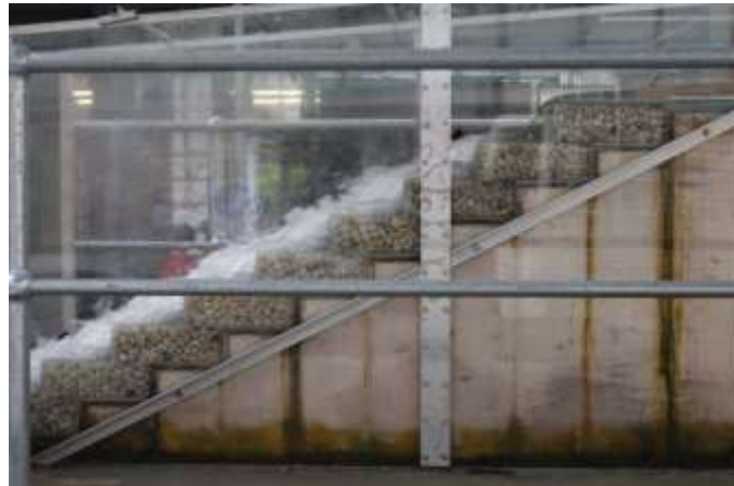
شکل ۱. شماتیک آزمایشگاهی سرریز پلکانی توری سنگی (Wüthrich and Chanson, 2014).
