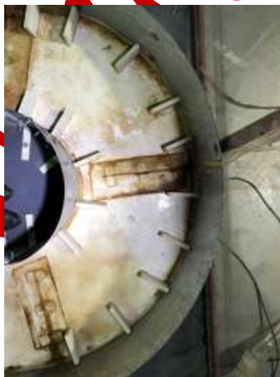
شکل ۲. نمونه‌ای از نحوه استقرار سرریزها در مجموعه آزمایش W_{R3-3} (کارگذاری سرریزها در دو طرف مسیر با فاصله نسبی ۱/۷)
