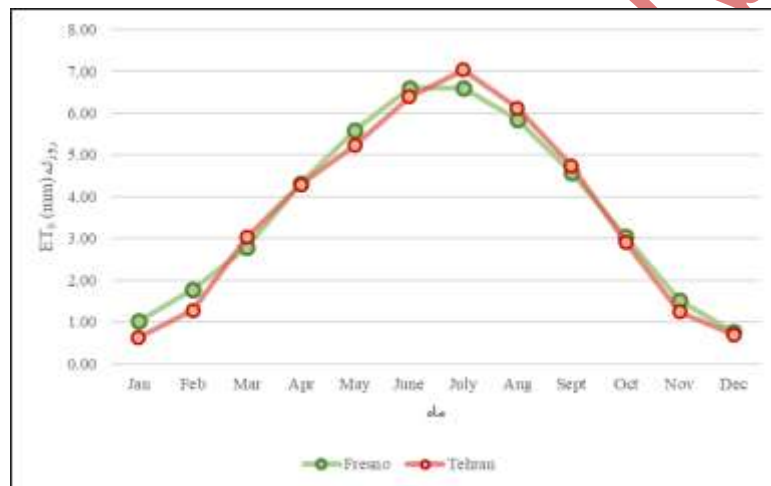
شکل ۴- مقایسه تبخیر-تعرق روزانه ایستگاه Fresno و فرودگاه مهرآباد
