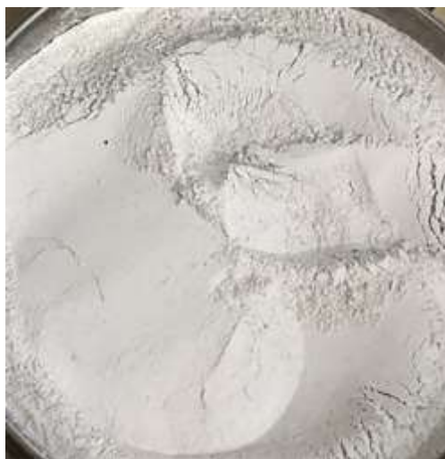
شکل ۱. پودر شیشه بازیافتی رد شده از الک شماره ۲۰۰
