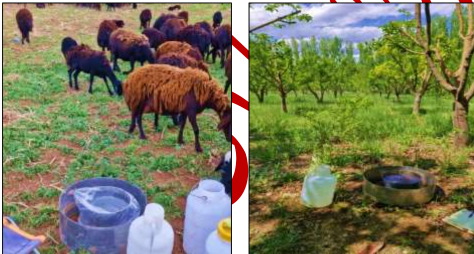
شکل ۲. آزمایش صحرایی نفوذ آب به خاک در کاربری باغ و مرتع
