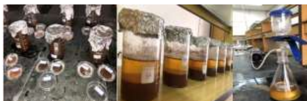
شکل ۲- مراحل آماده‌سازی و فیلتراسیون نمونه‌ها برای جداسازی میکروپلاستیک‌ها در آزمایشگاه
