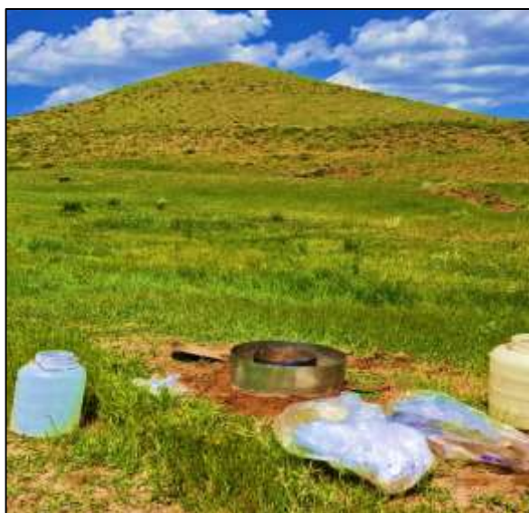
شکل ۲: اندازه گیری نفوذ آب به خاک در مناطق مورد مطالعه
