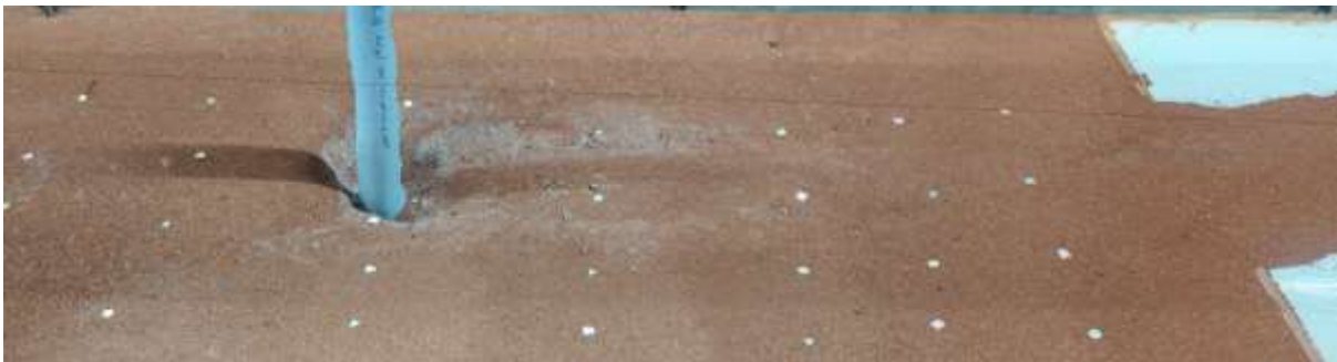
شکل ۱۸. مدل سه‌بعدی بازسازی‌شده از بستر ماسه‌ای در حالت ۵ درصد رس پلاستیکی با دبی ۳۰ لیتر بر ثانیه پس از گذشت ۲۱۰ دقیقه
