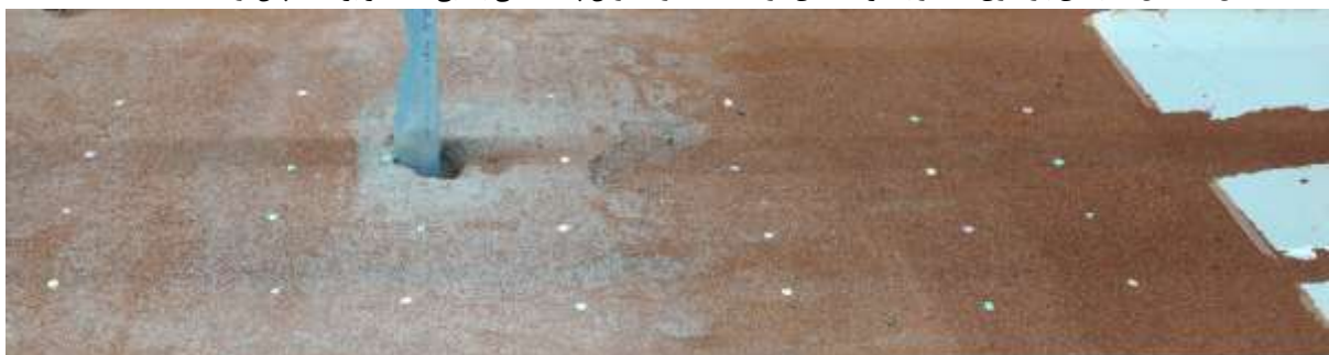
شکل ۲۰. مدل سه‌بعدی بازسازی‌شده از بستر ماسه‌ای در حالت ۱۵ درصد رس پلاستیکی با دبی ۳۰ لیتر بر ثانیه پس از گذشت ۲۱۰ دقیقه
