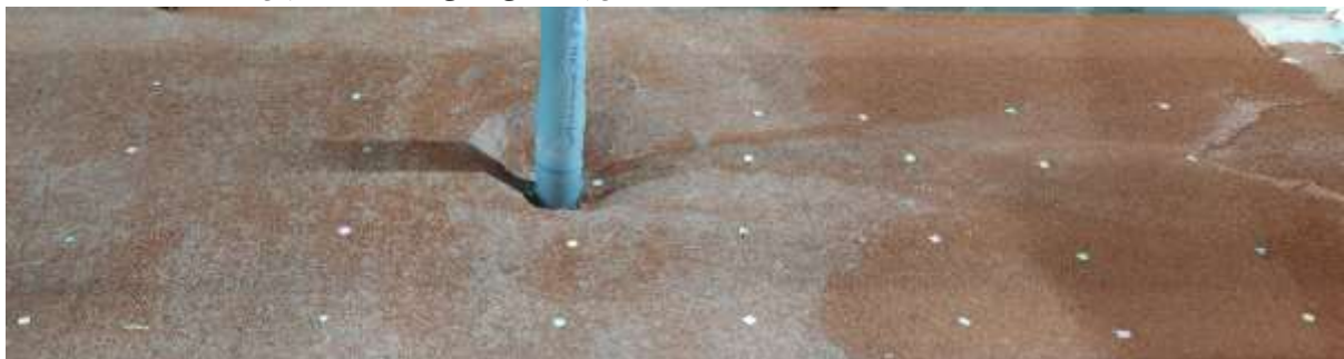
شکل ۱۹. مدل سه‌بعدی بازسازی‌شده از بستر ماسه‌ای در حالت ۱۰ درصد رس پلاستیکی با دبی ۳۰ لیتر بر ثانیه پس از گذشت ۲۱۰ دقیقه
