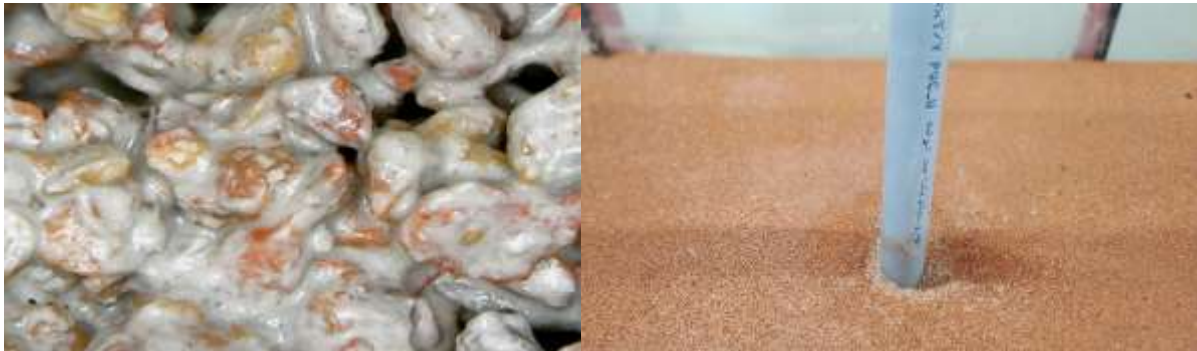
شکل ۳. تصویر آزمایشگاهی و نمای نزدیک از اختلاط رس پلاستیکی با بستر رسوبی
