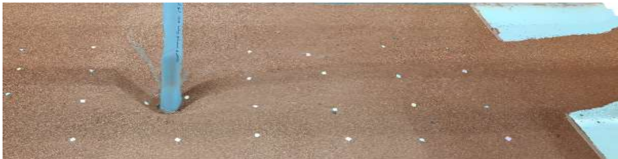
شکل ۱۷. مدل سه‌بعدی بازسازی‌شده از بستر ماسه‌ای در حالت شاهد (بدون رس پلاستیکی) با دبی ۳۰ لیتر بر ثانیه پس از گذشت ۲۱۰ دقیقه
