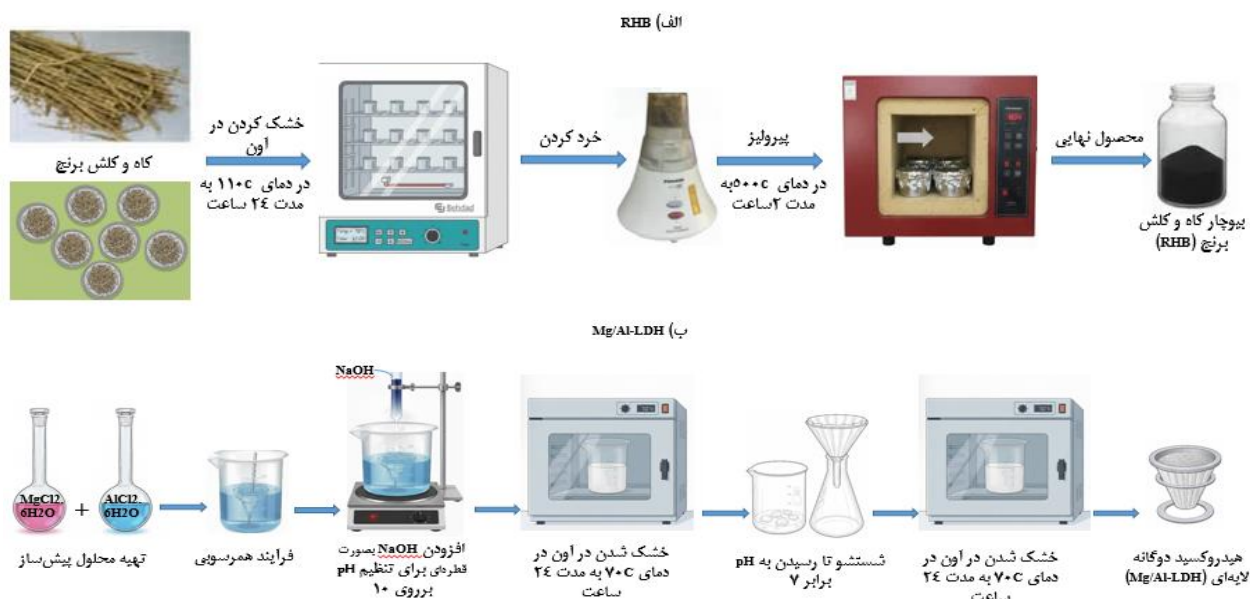
شکل ۱. نمای شماتیک از روش ساخت جاذب‌های مورد مطالعه: (الف) RHB و (ب) هیدروکسید دوگانه لایه‌ای (Mg/Al-LDH)
