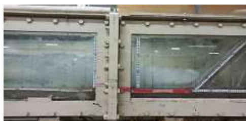
شکل ۲. نمایی از پرش هیدرولیکی نوع B در حالت عدم وجود آستانه
