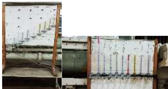
شکل ۱. نمایی از پیزومترهای نصب شده در کف کانال
