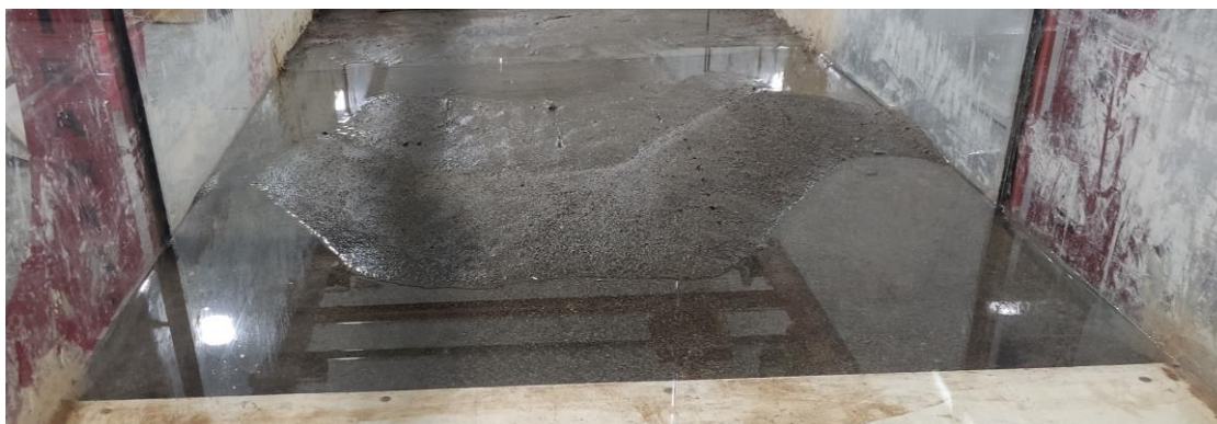
شکل ۱۸. نمایی از بستر رسوبی با دانه بندی S1 و درصد رس ۱۵ درصد پس از اتمام آزمایش
