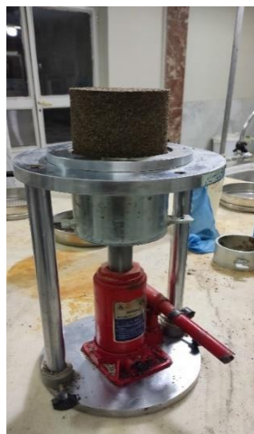
شکل ۴. نمایی از جک هیدرولیکی مورد استفاده در آزمایش تراکم پروکتور
