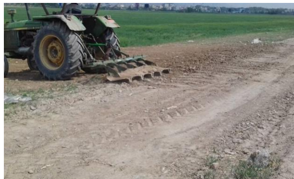
شکل ۱. نمایی از دستگاه شیار زن اتوبی و شیارهای ایجاد شده
