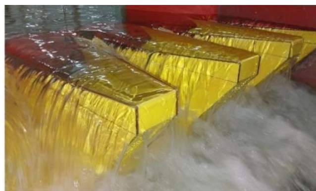
شکل ۳. سرریز کلید پیانویی ذوزنقه‌ای با شیب ۷/۵ درجه خلاف جهت جریان
