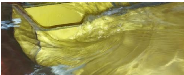
شکل ۴. سرریز کلید پیانویی ذوزنقه‌ای با شیب ۱۰ درجه در جهت جریان
