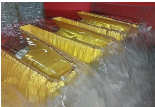
شکل ۲. سرریز کلید پیانویی ذوزنقه‌ای با شیب ۷/۵ درجه در جهت جریان
